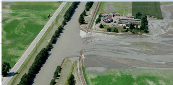
Abb. 9: Dambruch an der Aare bei Meiringen BE beim Hochwasserereignis am 24. August 2005 (© Schweizer Luftwaffe)
