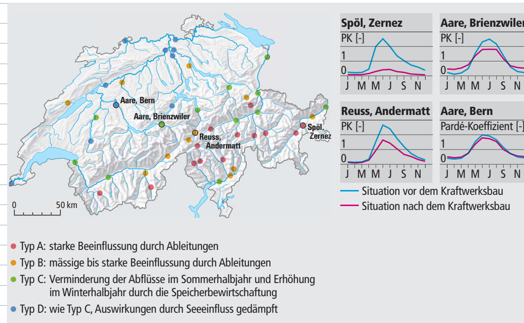
Abb. 5: Beeinflussung einiger Fließgewässer durch Kraftwerke (nach Spreafico M., Weingartner R., 2005)
